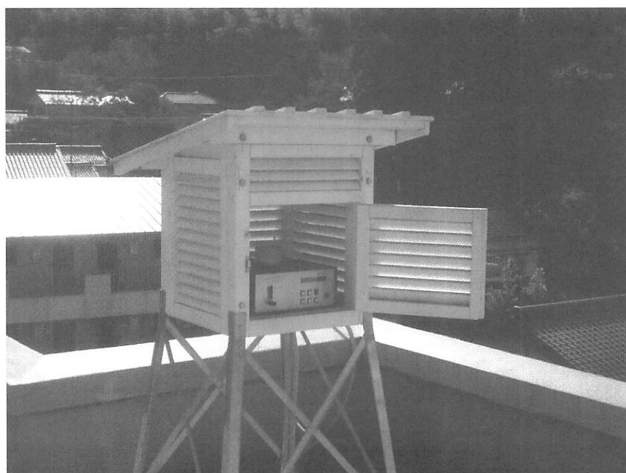
図1 (b) 計測器は設置基準に従い百葉箱の中に設置した
